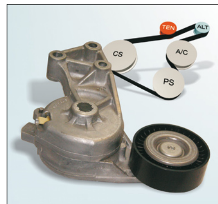
Foto 2: Dźwignia napinacza 534 0132 30 montowana w silnikach 1.9 TDI wraz ze schematem paska
